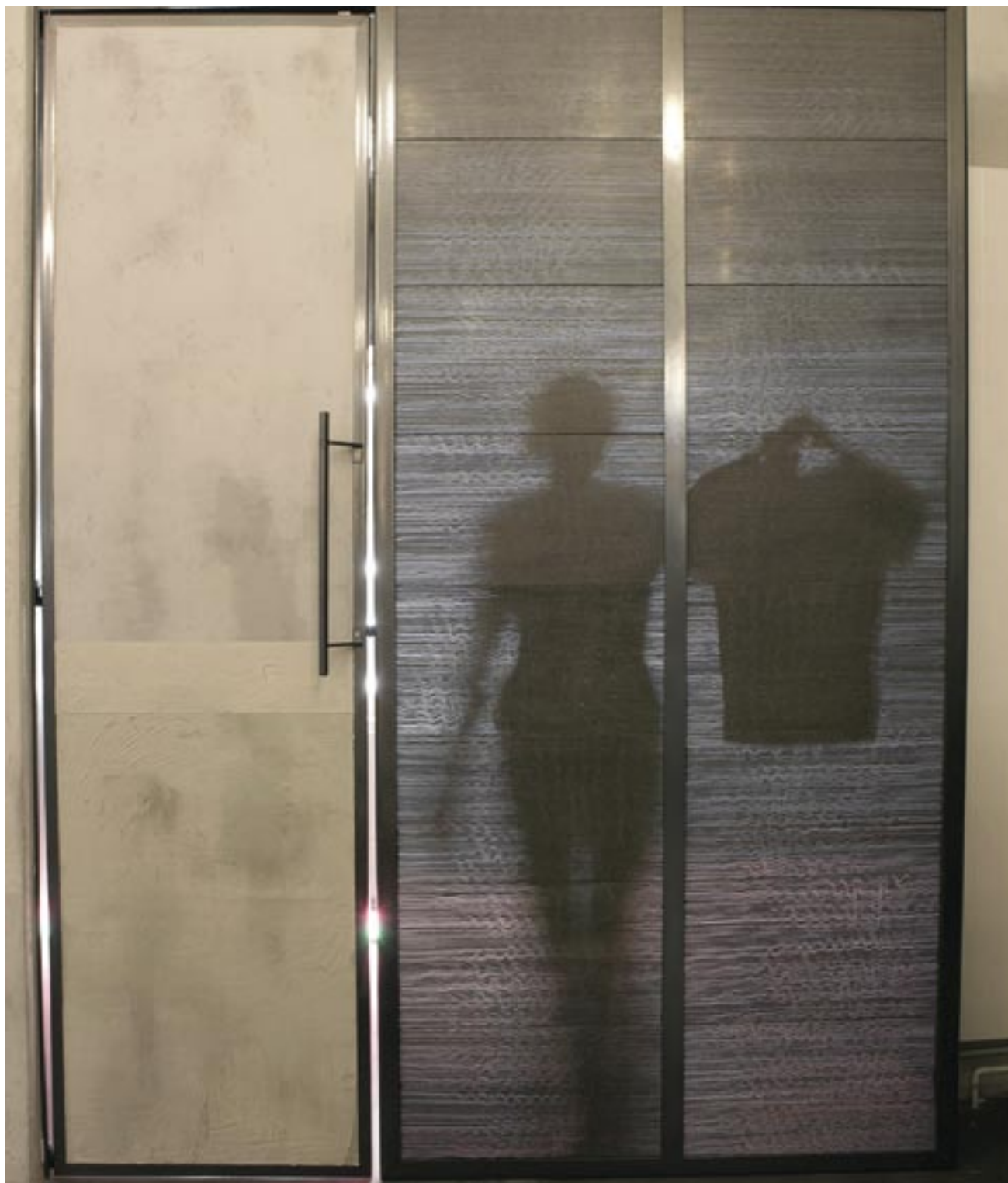
Optiske fibre (tykkelse < 2 mm) transporterer lys gjennom betong i inntil 20 meters lengde. Dette gir mulighet for lysinnslipp, samtidig som betongens konstruktive og varmelagrende egenskaper kan utnyttes fullt ut.
