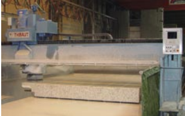
Slipeprosessen (bildene er tatt hos AS Betong)
