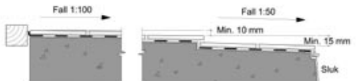
Figur 5: Nedsenket dusjgrube; høydeforskjell mellom slukrist og gulv ved dør
