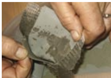
Fugebåndet må være av en kvalitet som tåler påkjenningen. Svikter fugen, har dette store følgeskader.
