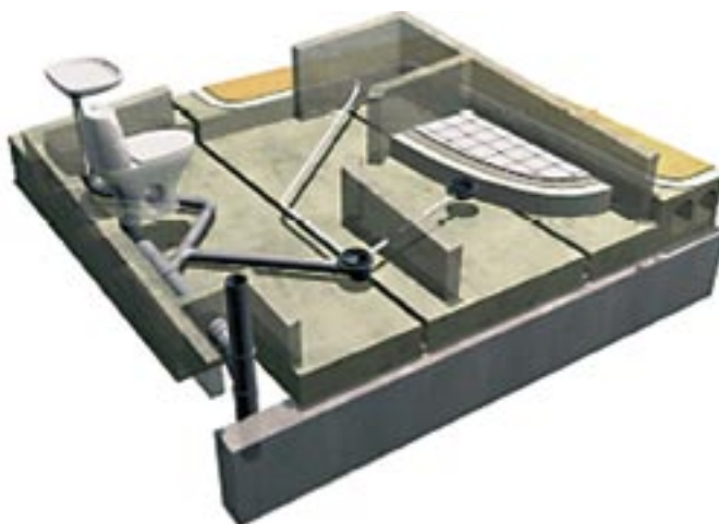
Figur 6: Et nedsenket våtromsdekke gir løsninger uten høydeforskjell mot tiliggende rom. Det kan benyttes over- eller underliggende membran til påstøpen. Benyttes underliggende membran, anbefales i tillegg påstrykningsmembran i selve dusjsonen for å holde gulvet tørrest mulig.
