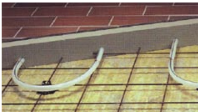
Figur 1: Varmeslyng på armeringsnett
