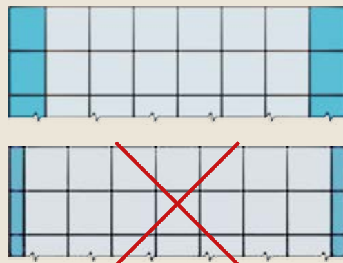
Figur 10: Eksempel på riktig og feil inndeling av flisflate
