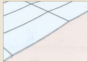
Figur 5: Forskjøvet forband kan gi uønskede sprang mellom flisene
