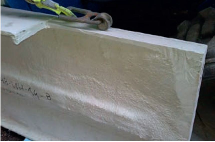
Fiberbetong produseres av sement, fint tilslag og 4-5 % glassfiberarmering, enten ved sprøyting eller ved støping i form. Vekt: 25 kg/m 2 i 12 mm tykkelse
