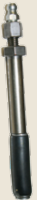
Injisering av riss: Såkalte pakkere borres inn på skrå av rissene og fylles med epoksy vha en injeksjonspumpe
