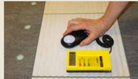
Figur 3: Med et luxmeter kan man beregne luminanskontrast både på prøvefliser og på ferdige flater
