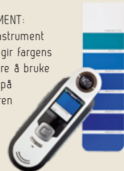
Figur 4: Eksempel på utstyr som identifiserer NCS-koder og måler refleksjonsfaktoren. Kilde: NCS Colour Centre
