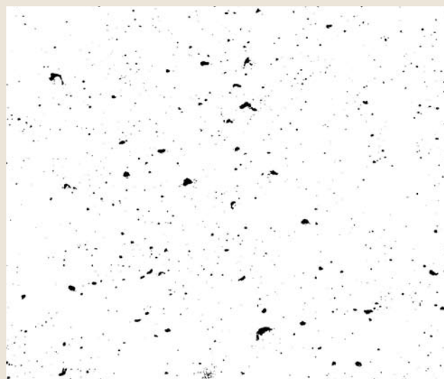
Figur 3: Registrering av porer ved hjelp av programvaren Image J
