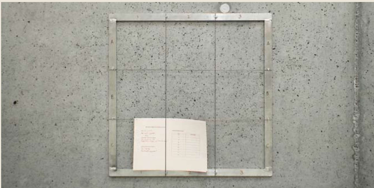
Figur 1: Utvalgt område for beregning av porefordeling og gråtonejevnhet
