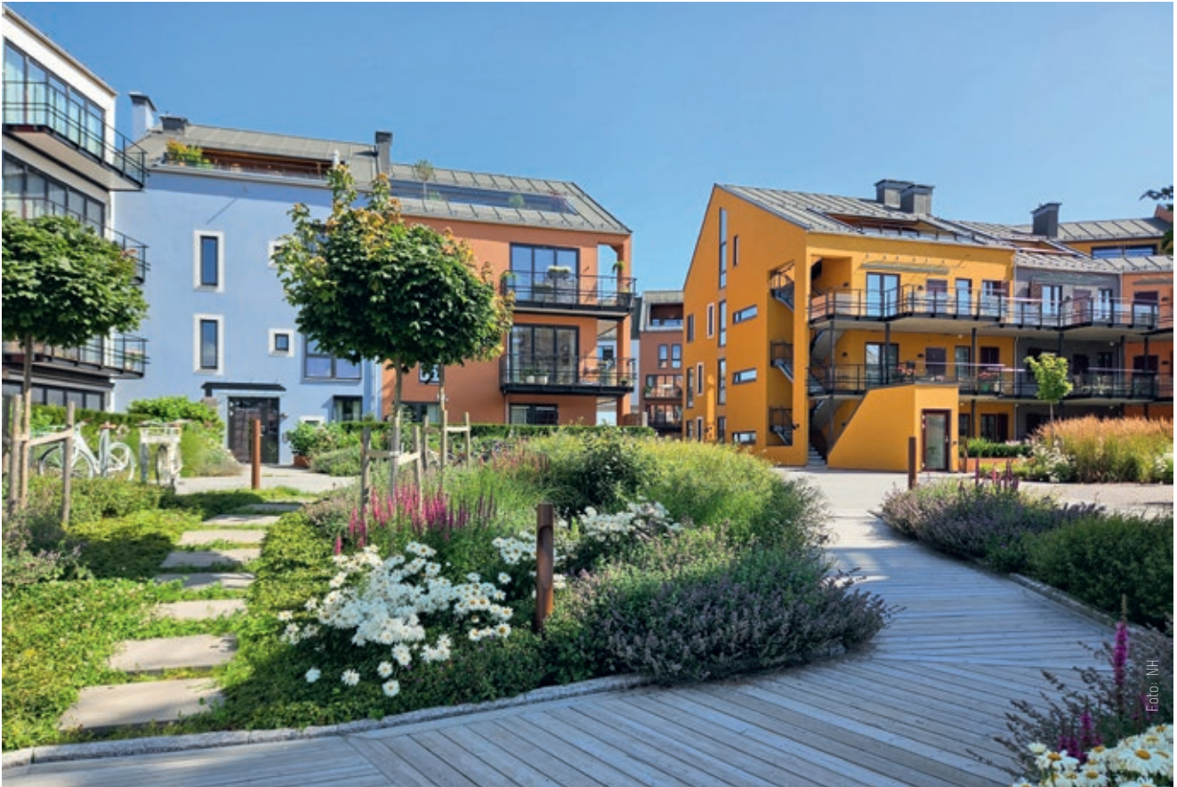
Fasadene måtte tåle tøft og rått klima med sjøsprøyt. Ønsket var vedlikeholdsfrie pussfasader, og valget falt på et luftet fasadesystem med puss på plate
