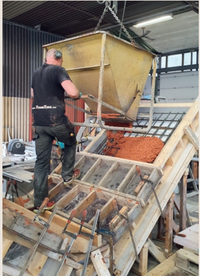
Alle deler av sitte-/liggeelementet er støpt i hvit betong tilsatt rødt og gult pigment for å få en oransje kulør
