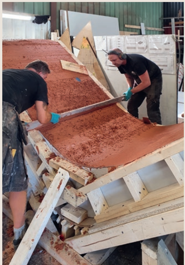
Alle deler av sitte-/liggeelementet er støpt i hvit betong tilsatt rødt og gult pigment for å få en oransje kulør
