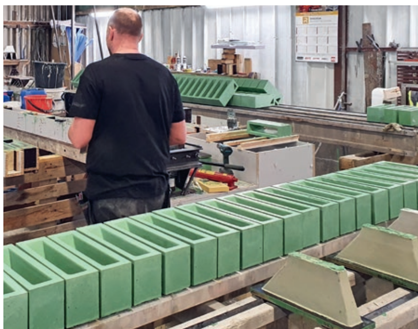
Etter utstøping, herding og avforming ble kanter og grader slipt ned før elementet ble behandlet med sealer
