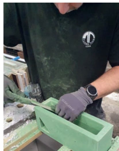
Etter utstøping, herding og avforming ble kanter og grader slipt ned før elementet ble behandlet med sealer
