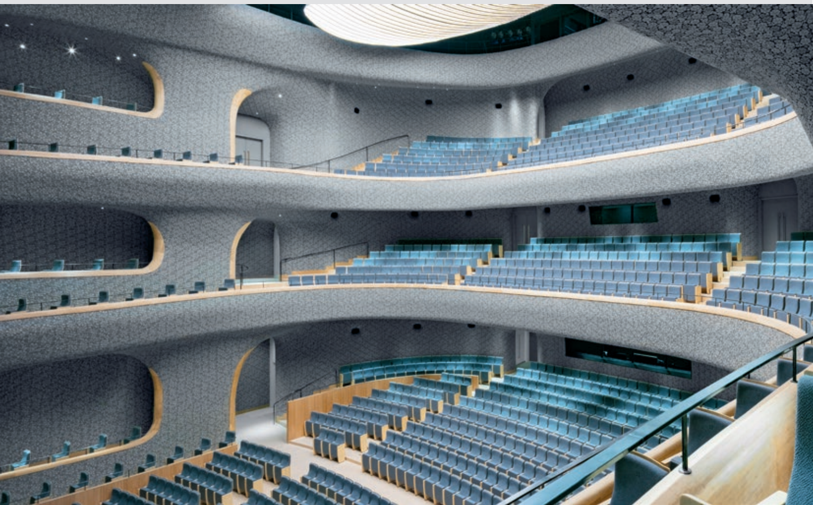
To typer akustiske keramiske paneler: Konsertsalen har mangefasetterte geometriske fliser, mens ornamentale, 8 mm tykke keramiske blomsterfliser i varme gråtoner danser over buede former i operahuset
