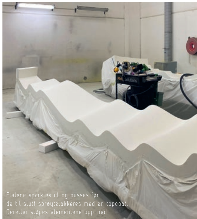
Formene er bygget opp med EPS som maskineres i fresemaskinene
