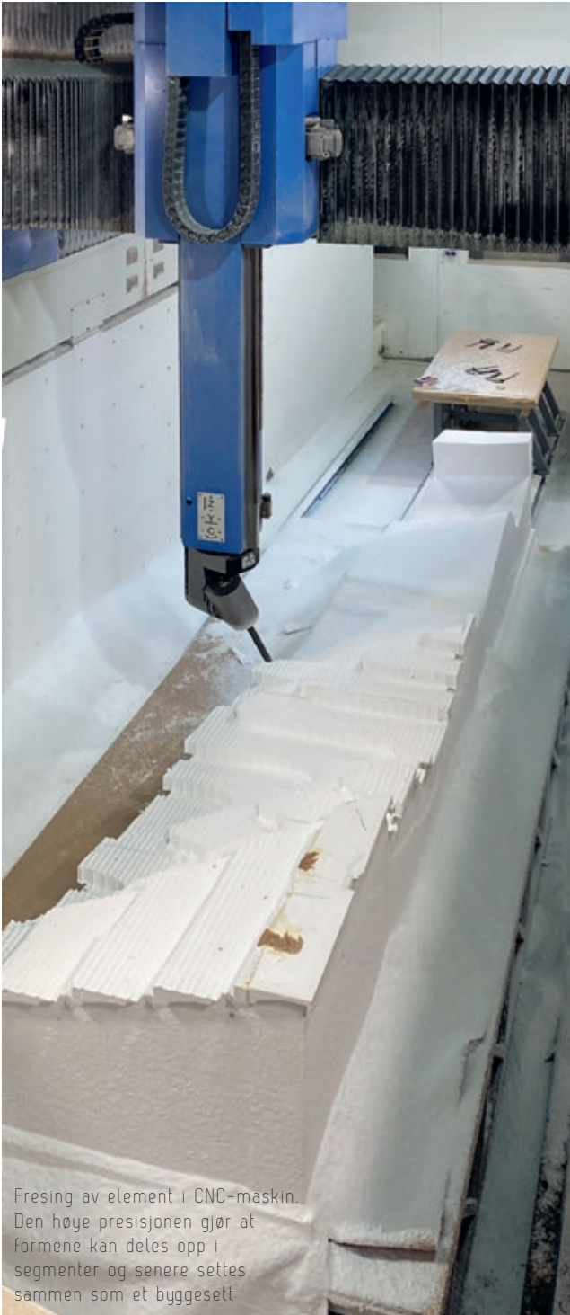
Formene er bygget opp med EPS som maskineres i fresemaskinene
