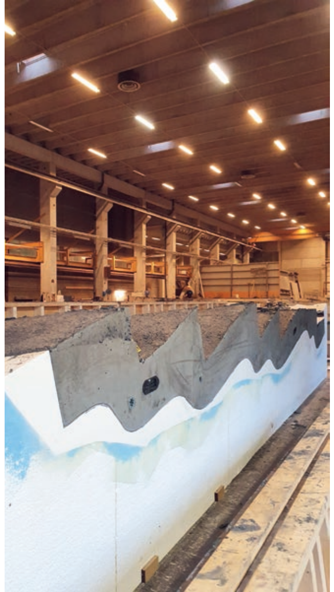
Elementene er støpt med B35MF40-betong med 6% sort pigment. Foruten tradisjonell stålarmering er det også brukt en komposittfiber. Alle elementer bortsett fra det aller minste har innstøpte varmekabler. Fire av de største elementene har også kanaler i overflaten for plassering av kassetter til LED-belysning
