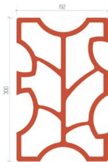
Ett keramisk element, 192x300x60 mm
