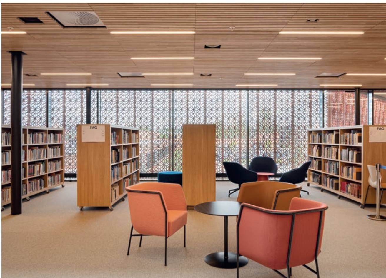
Keramiske solskjermingselementer beskytter fasaden, begrenser sollys og innsyn, skaper lysspill og tilfører taktilitet og farge
