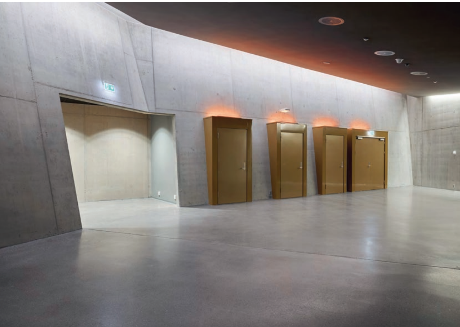
Belysningen over dørforingene illuderer fakler. LED-belysning med dagslyssimulering i spalten mellom himling og betongvegger illuderer dagslys som siver ned gjennom sprekker i fjellet
