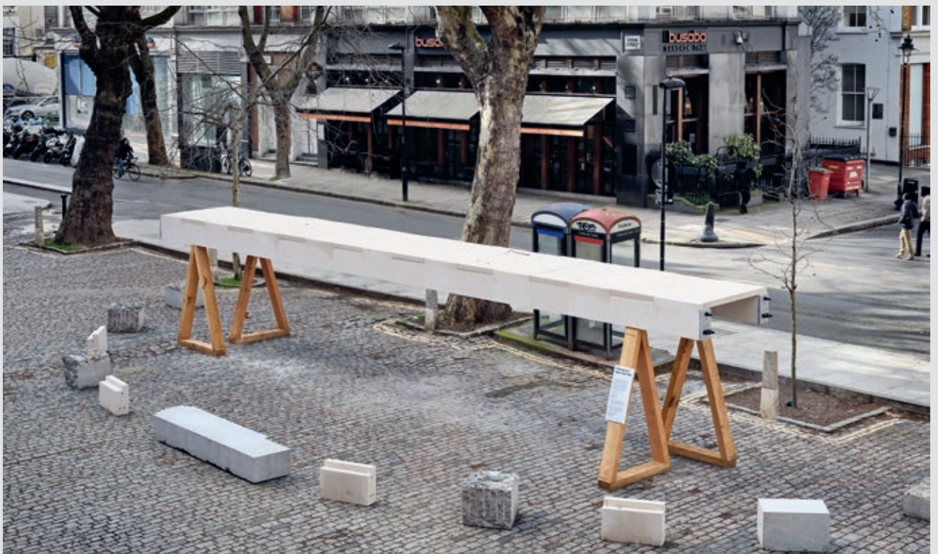
Etterspente dekkeelementer i naturstein. Fra utstillingen The New Stone Age på The Building Centre i London, 2020. Foto: John MacLean
