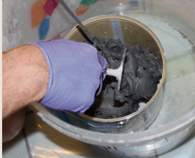
Figur 6a: Epoxymassen har seig konsistens slik at den ikke skal bli oppløst i vannet før den herdner
