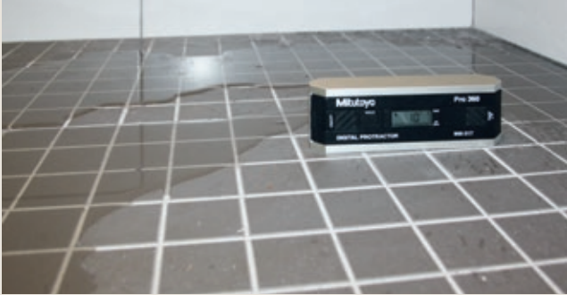
Figur 5: Test med vann. Vannets overflatespenning gjør at det må ha et fall på minimum 1:200 for å renne mot sluk
