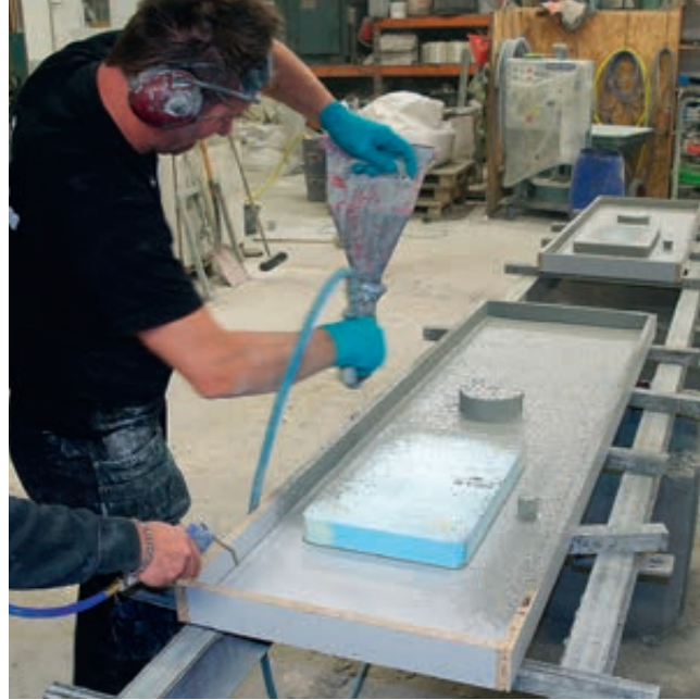
2-4 mm fiberfri 'facecoat' sprøytes på
