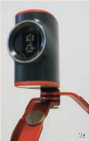
Figur 2: Elektroniske lengdemålere registrerer lengder og beregner høydeforskjeller
