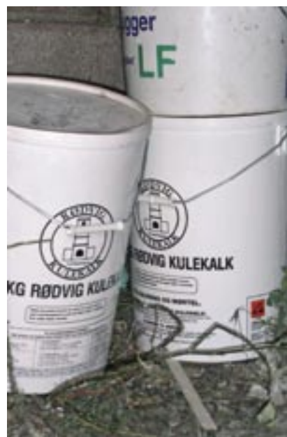
fig. 2 Lagret kulekalk til fugemørtelen. Sandens kornkurve var 0,2–2,5 mm. Blandingsforhold kalk: sand er 1:3. 10 % brent umbra
