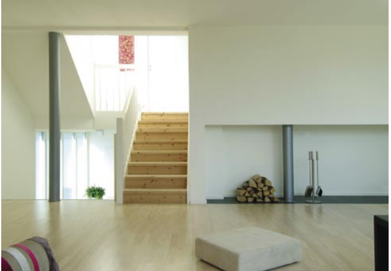
Overlapping i halvplan gir rom for en fire meter lang peisnische i stuen
