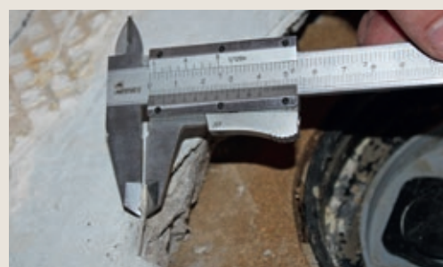
Figur 4: Vurdering av membranens tilstand, bl.a. tykkelse, fabrikat og alder, inngikk i undersøkelsene
