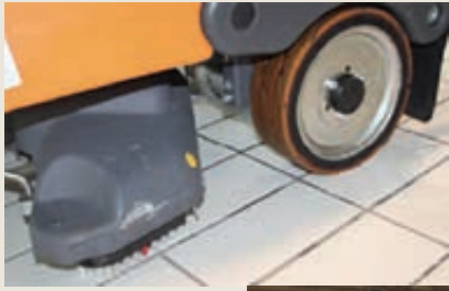
Figur 8: Rengjøringsmetoden er avgjørende for bestandigheten av fugene. Kraftig høytrykkspyling, harde hjul og stive børster reduserer fugenes levetid.
