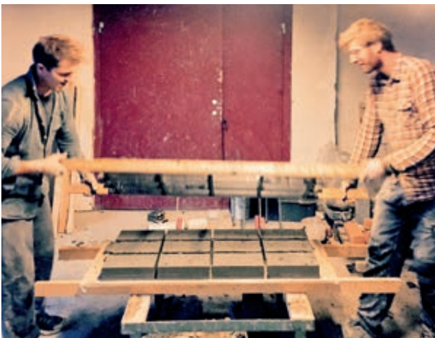
Teglproduksjon i liten skala: elting, avforming og brenning
