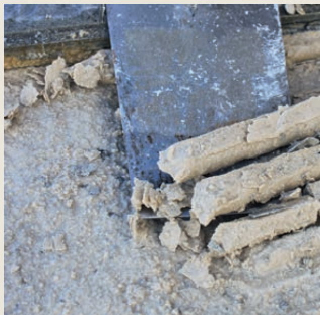
Figur 4: Frostskadet lim kan smuldre opp og miste fasthet.
