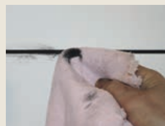
Figur 5: Sure rengjøringsprodukter gir avsmittning fra mørke fuger
