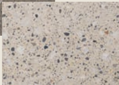
Slipte gulv med forskjellige typer tilslag og sement
