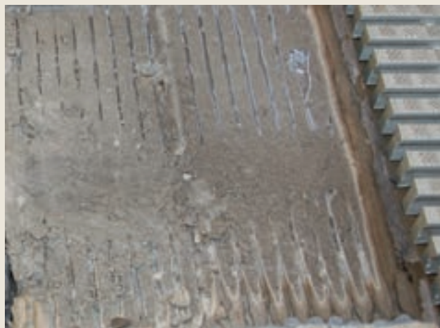
Figur 6: Slakteprøven viser et eksempel hvor flisen ikke er dobbellimt, heller ikke arbeidet godt ned i limet
